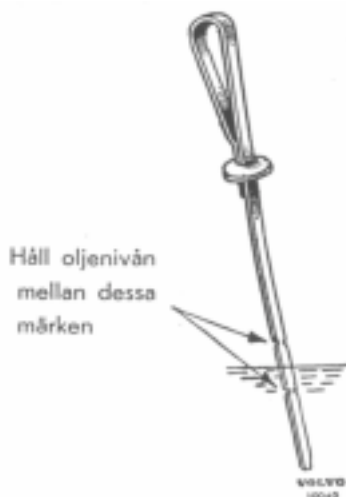
Bild 36. Oljemätsticka.
